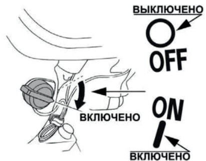
Рис. 11. Выключатель зажигания в положении «Включено»
